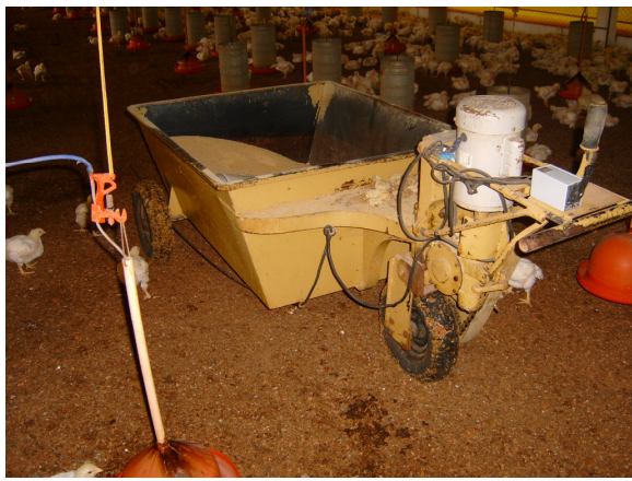
Figura 7. Modelo de equipamento para distribuição de ração utilizado em aviários manuais.
