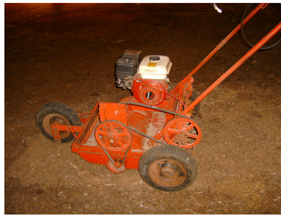
Figura 8. Modelo de mini-tractor utilizado para revolver a cama aviária.
